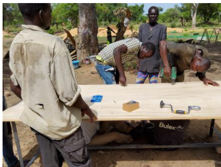
Les bureaux pour l'administration de l'école sont fabriqués ici. La base en métal soudé et la surface en panneau de 2 cm d'épaisseur.
